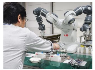
D：人型双腕ロボットと一緒に塗装機部品の組み立て作業を体験できる
