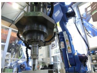
A：世界初披露となる国産高剛性ロボットを使った切削加工システム
