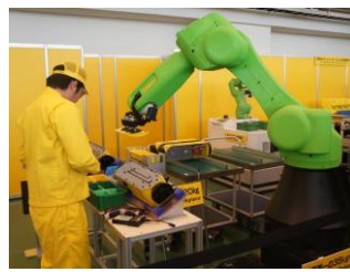
C：最大可搬質量35kgの協働ロボットを使って重筋作業を肩代わり
